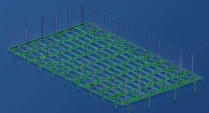
Nuestra plataforma elevada ha sido diseñada por el departamento de ingeniería de PORTICO SPORT, siguiendo procedimientos rigurosos, que incluyen análisis sísmico, limitación de deformaciones y verificación de elementos estructurales conforme a las normativas ASCE 7-SEI 2019 y AISC 360 2016 (LRFD), garantizando seguridad y calidad en cada detalle.
